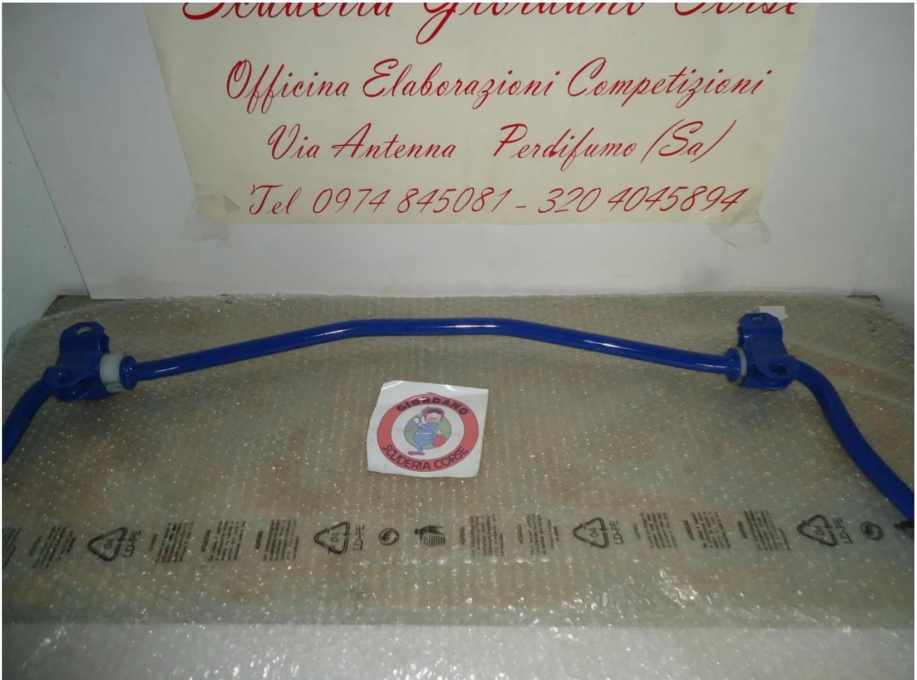
2 boccole in tecnoplastica per barra stabilizzatrice anteriore attacco alla scocca
